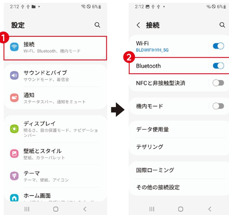
③ BluetoothをONにして、接続可能な機器のリストから「A-Surfer Hybrid\_B/O」を選択します。
