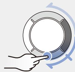
**① [低速スクロール]上下スクロール** PCでのみ動作します
